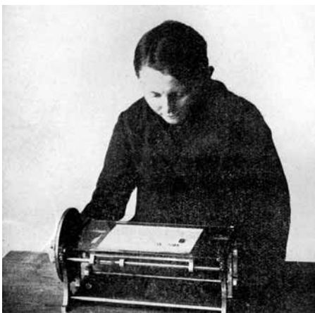
Optometer zur Prüfung von Sehschärfe und Augenmaß.
